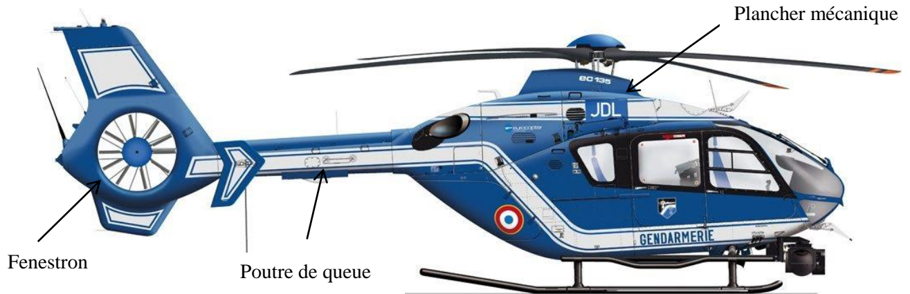
Figure 1 : Exemple de parties techniques de l'hélicoptère H135 de Airbus Helicopters
